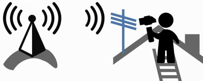
Антенна должна быть направлена на вышку сотовой связи и расположена строго вертикально. Кабель с разъемом должен располагаться с нижней части антенны.
