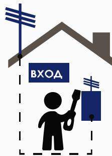
**Шаг 3.** Выберите место для установки комнатной антенны **MWA-825-PI9S** (только для комплекта MWK-9-N). Комнатная антenna должна располагаться с тыльной части уличной антенны, то есть не попадать в ее луч. Уличная и комнатная антенны должны быть разнесены по высоте минимум на 2-3 метра. Дополнительные преграды между антеннами – металлическая крыша, железобетонная стена и т.п. улучшит связь между антеннами и увеличит уровень ретранслируемого сигнала. Чем больше стен между антеннами, тем лучше!
